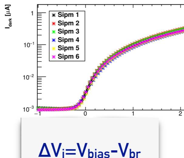
$V_{\text{br}}$  from LNF fit
