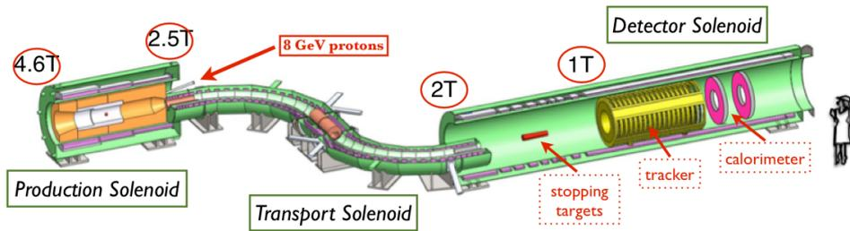
Figure 2 – Mu2e apparatus.
